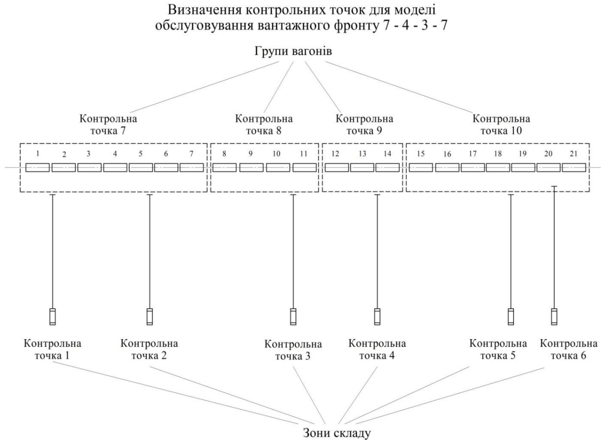
Рисунок 4.5 – Схема розташування контрольних точок моделі «7-4-3-7»
